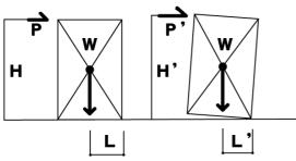
支点Aを中心に水平力により時計回りに回転しようとする。これに対し自重が支点Aを中心に反時計回りに回転しようとする。回転するかどうかは、自重・高さ・幅そして水平力の大きさで決まる。
