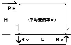
時計回りに回転しようとする、回転力(モーメント)Mは M=水平力(PH)×高さ(H)〈単位:T・M〉で表わせる。
